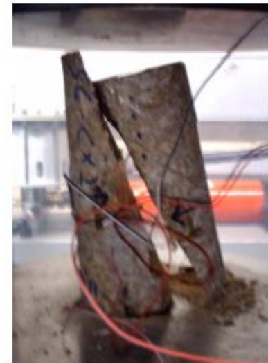
Figuras 22,23 e 24. Amostras pós-rotura com fracturas que fazem entre 30° e 45° com a direcção da aplicação da pressão.
