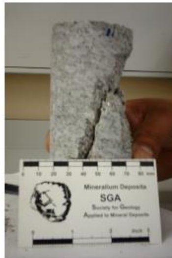
Figuras 22,23 e 24. Amostras pós-rotura com fracturas que fazem entre 30° e 45° com a direcção da aplicação da pressão.
